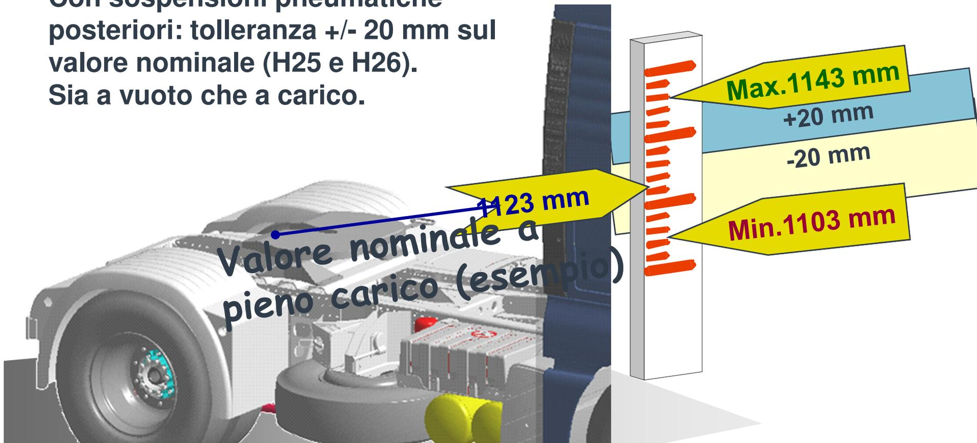
**Attenzione! Al bisogno l'altezza di marcia delle sospensioni di serie a carico (H26) si può correggere con MANCats di pochi millimetri (max. 15 mm). Serve, al bisogno, a recuperare parte della tolleranza (+/-20 mm)**
