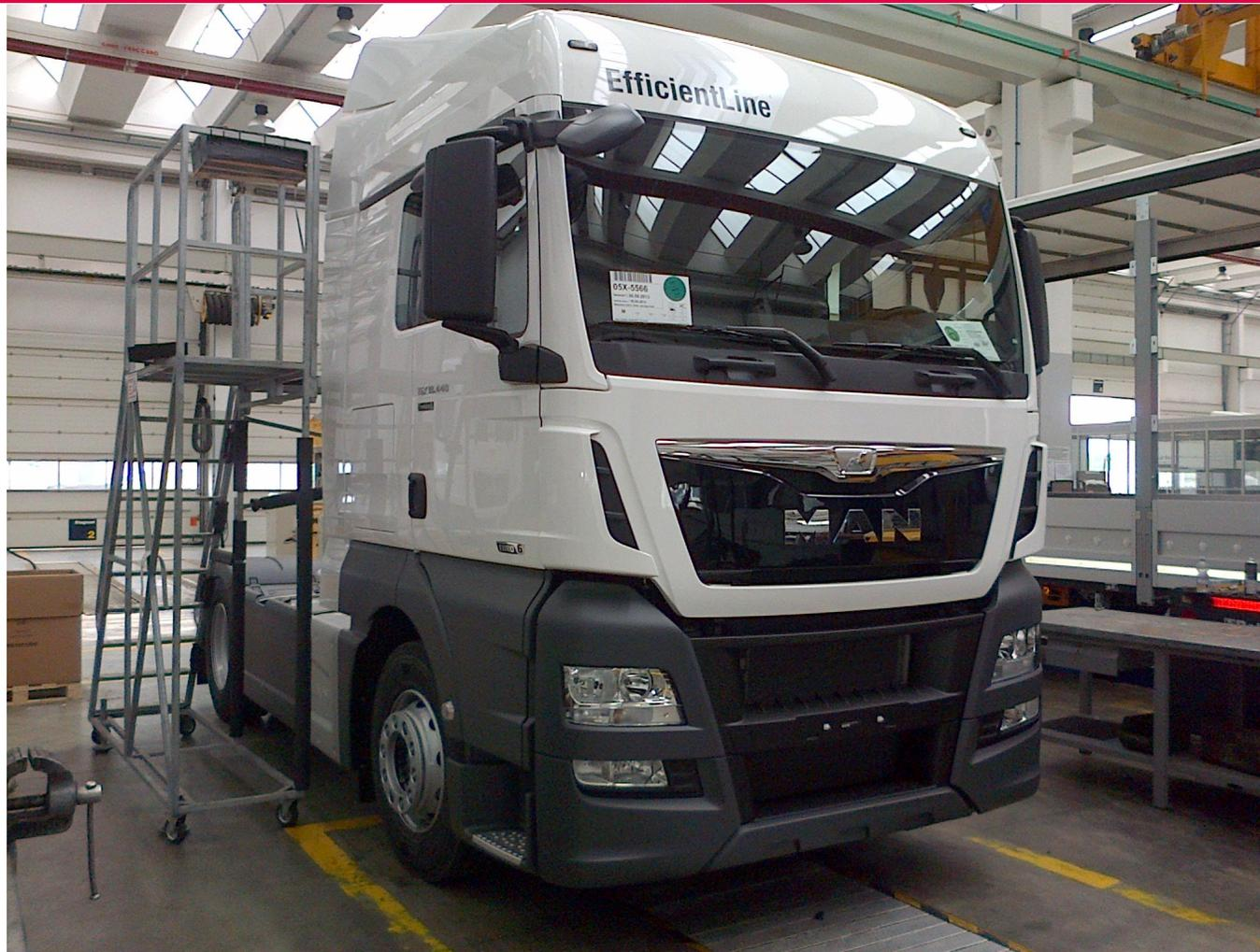
Nell'immagine la colorazione di serie di un TGX Euro 6 le superfici di paraurti, specchi, zona gradini, carenature laterali non sono verniciate ma grigioscuro gofrato.
